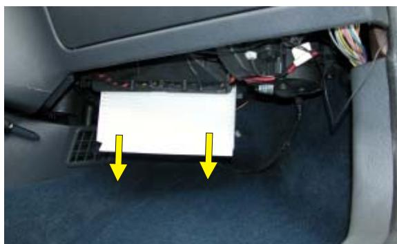
(PL) Ostrożnie usuwać zabrudzony filtr, następnie zamontować nowy oraz wykonać powyższe czynności w kolejności odwrotnej
